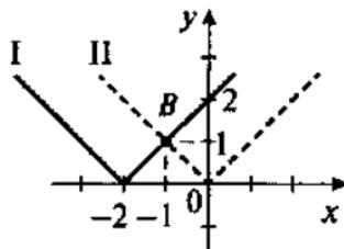
Теперь рассмотрим линейную функцию  $y = ax + b$ . По условию ее график проходит через точки  $A(1; 5)$  и  $B(-1; 1)$ . Поэтому координаты этих точек удовлетворяют уравнению линейной функции. Получаем систему уравнений  $\begin{cases} 5 = a + b, \\ 1 = -a + b. \end{cases}$
