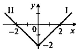
Аналогично предыдущему примеру для значений  $x \geq 0$  построим график функции  $y = x - 2$  (прямая I), для значений  $x < 0$  строим график функции  $y = -x - 2$  (прямая II). Область определения данной функции — все числа  $x$ , область значений — числа  $y \geq -2$ .
