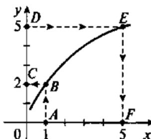
а) На оси абсцисс отложим точку  $A$ , для которой  $x = 1$ . Из точки  $A$  восстановим перпендикуляр к оси абсцисс до пересечения с графиком функции в точке  $B$ . Из точки  $B$  проведем перпендикуляр к оси ординат до пересечения с ней в точке  $C$ . Ордината точки  $C$  равна  $y = 2$ . Следовательно, при  $x = 1$  значение данной функции  $y = 2$ .
