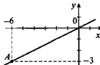
Так как функция  $y = kx$  — прямая пропорциональная зависимость, то ее график проходит через начало координат. Поэтому через начало координат и точку  $A$  проведем прямую — график данной функции. Так как график проходит через точку  $A$ , то ее координаты удовлетворяют уравнению функции. Поэтому получаем  $-3 = k(-6)$ , откуда  $k = \frac{1}{2}$ .
